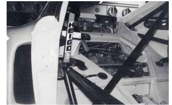
Frühjahr 1989: Der reinrassige Gruppe-C-Rennmotor erfordert einen Hilfsrahmen zur Chassisverstärkung
